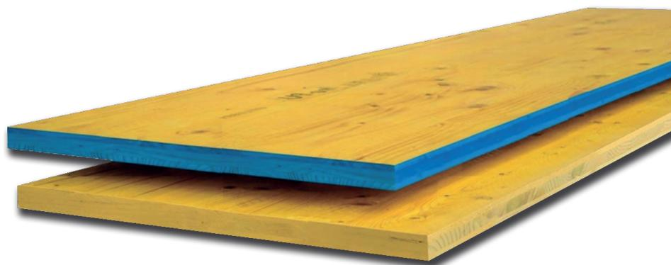
Tablero de encofrar con tres capas de madera encoladas entre sí, las dos exteriores en sentido longitudinal y la interior en sentido transversal.
